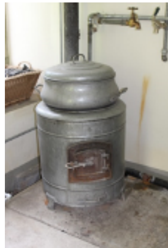
Holzbefuerter Waschherd Foto: Industrie-ensemble.ch
